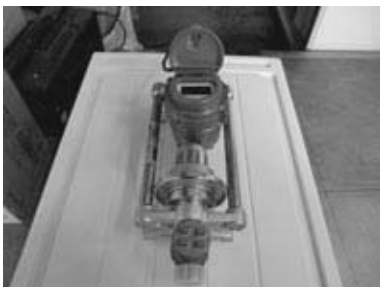
地下に設置されている水道メーター本体 (当別町で現在使用されているもの)
