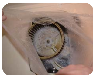
外した部品を洗剤に浸している様子
