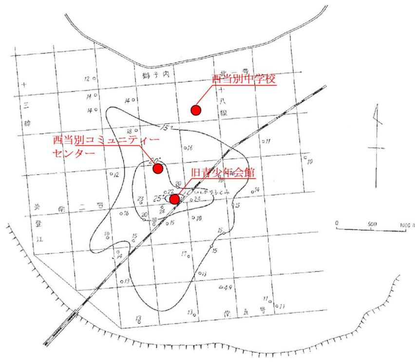
図 3.3.1 石狩太美付近の地下水温度分布図 (赤丸・赤字本業務で加筆)
