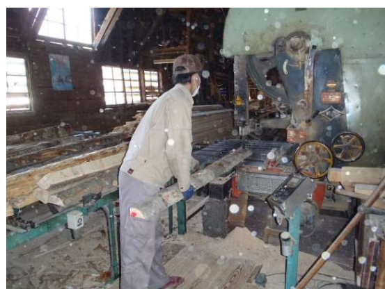
図4 原木を帯鋸盤にてカット
