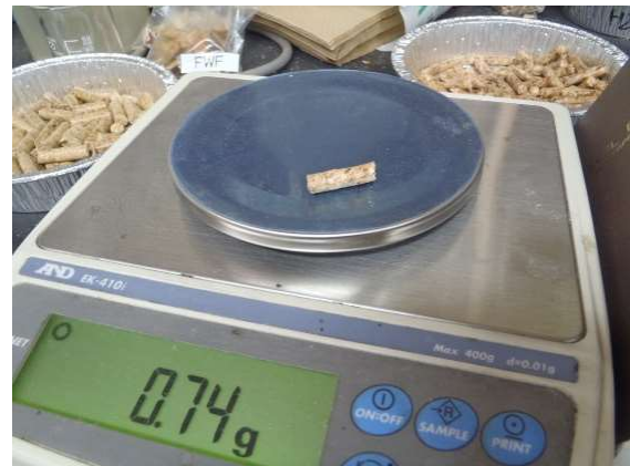
図 13 ペレット計測(重量)
