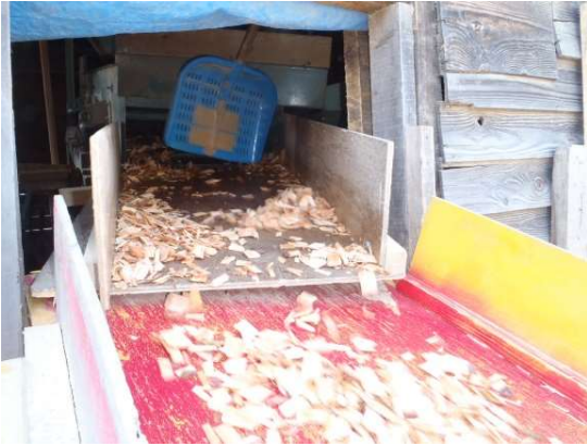
図5 切削チップ機にてチップ化
