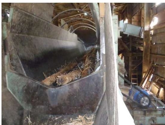
図3 皮むき機(トドマツのみ)
