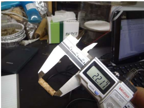
図 12 ペレット計測(長さ・直径)
