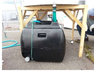
図 6 溶液循環タンク
