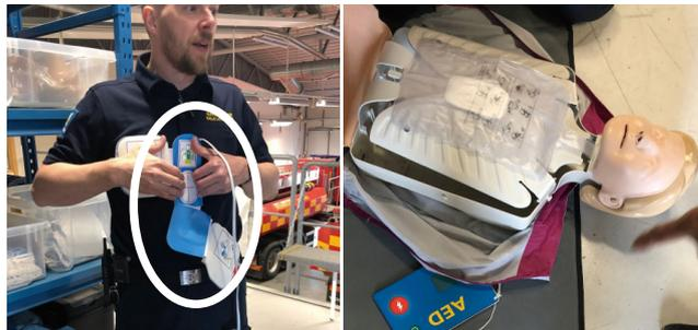
日本の一般的なAEDとは異なり、電気ショックに加え、胸骨を圧迫するためのシート（写真左：胸の部分）が装備されている。
