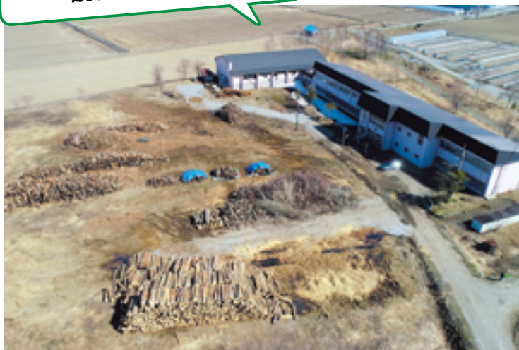
写真上にストックされているのが河川支障木。写真下の丸太が間伐材。これら資源を木質チップとして加工。
