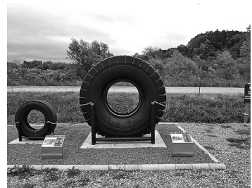
写真6 工事車両の55t 重ダンプのタイヤ（直径2.2m）
