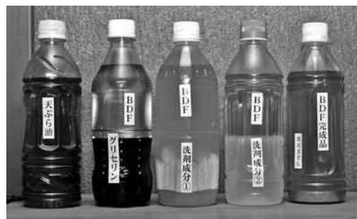
精製の段階(左から) 天ぷら油→BDF完成品
